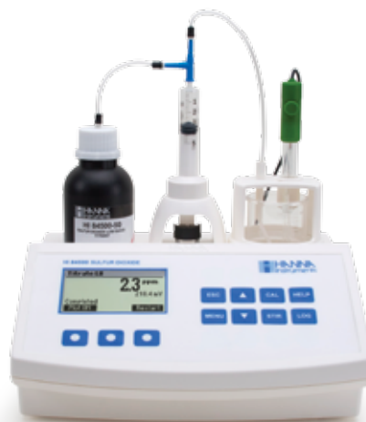
Reactivos y accesorios del minititulador de dióxido de azufre para análisis de vinos HI84500
